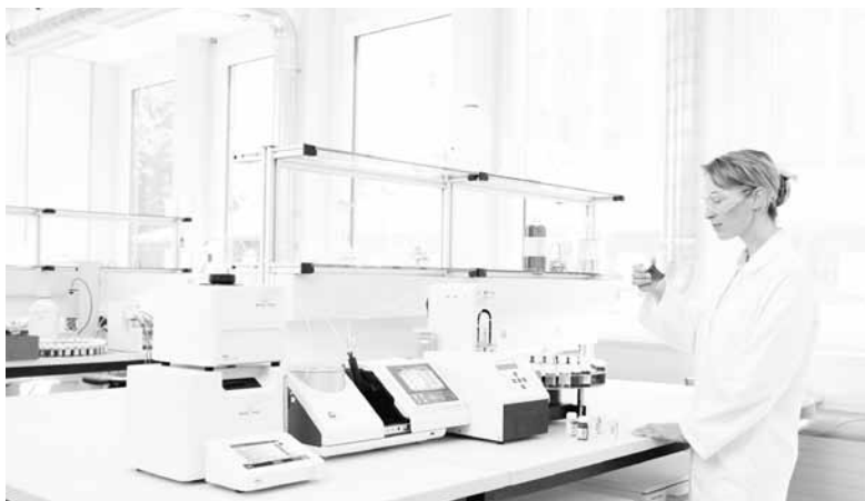
Le système multiparamètres permet la mesure automatisée de la masse volumique, indice de réfraction, pH/conductivité et couleur.
